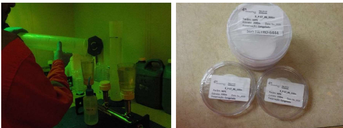
Figura IV.2.2-1 – Filtragem à bordo para determinação de MPS (esquerda) e acondicionamento das amostras (direita) durante a 9ª Campanha de Monitoramento do FPSO P-57.
