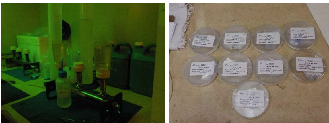
Figura IV.3.1-1 – Processamento à bordo para determinação de Clorofila a (esquerda) e acondicionamento das amostras (direita) durante a 9ª Campanha de Monitoramento do FPSO P-57.
