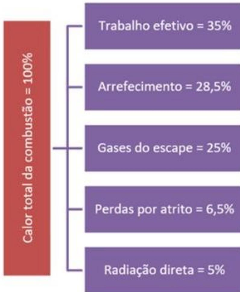
Balanço térmico típico de um motor diesel de combustão interna.
