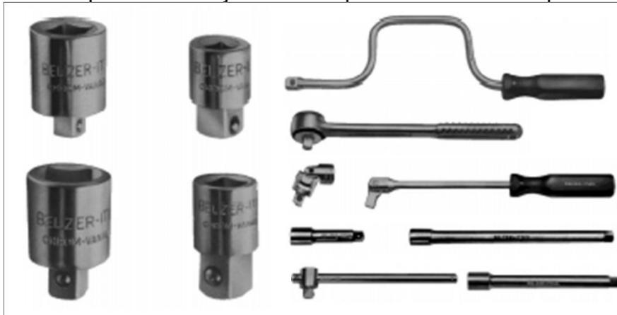
Os soquetes comuns não devem ser utilizados em máquinas elétricas ou pneumáticas, pois não resistem às altas velocidades e aos esforços tangenciais.
