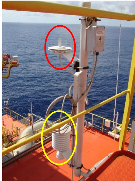
Figura 3. Sensores escalares YOUNG instalados em PPER-1. Em vermelho, o sensor de pressão atmosférica. Em amarelo, o sensor de temperatura e umidade relativa do ar.
